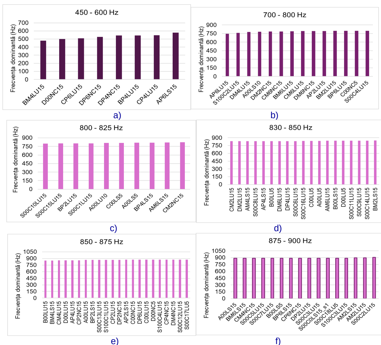
Fig. 16. Gruparea viorilor testate în funcție de valoarea frecvenței dominante: a) între 450 – 600 Hz; b) 700 – 800 Hz; c) 800 – 825 Hz; d) 830 – 850 Hz; e) 850 – 875 Hz; f) 875 – 900 Hz
