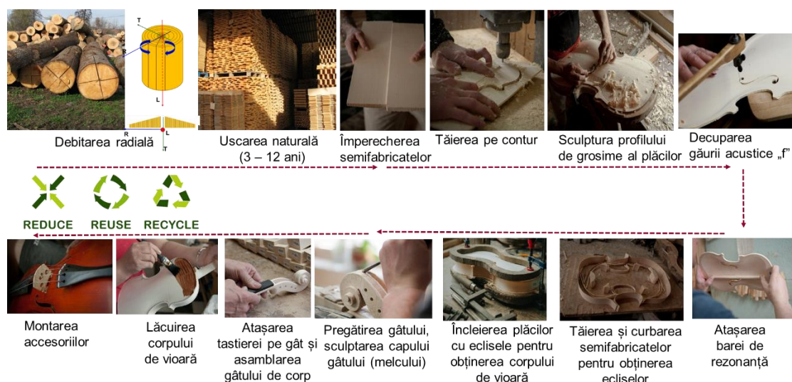
Fig. 1. Principalele operații tehnologice din construcția viorii
