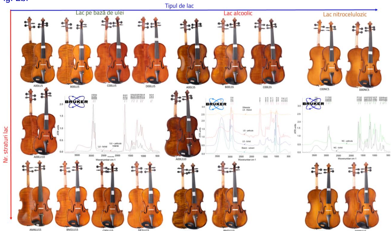
Fig. 4. Tipuri de viori testate din punct de vedere al lacurilor și grosimii peliculei de lac
