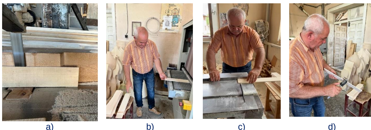
Fig. 2 Secvențe din timpul pregătirii probelor: a) spintecare; b) calibrare; c) retezare; d) verificare dimensiuni finale
