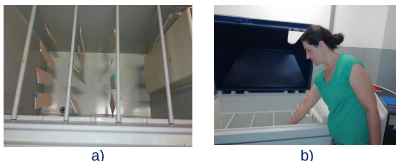
Fig. 21. Expunerea probelor în camera de ceață salină: a) poziționarea probelor în cuva echipamentului; b) verificarea probelor
